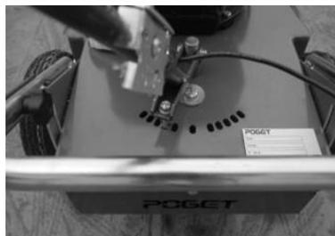
**-AVANT TOUT CHANGEMENT DE SENS DE ROTATION, LAISSEZ LA BROSSE S'ARRETER EN MANITENANT LE LEVIER EN POSITION NEUTRE AFIN D'ÉVITER UNE USURE PRÉMATURÉE DES COURROIES.**
